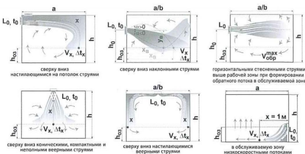
Рисунок Ж.1 - Основные схемы подачи приточного воздуха
